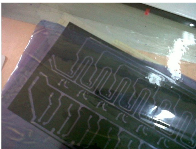
Figura 95. Tarjeta de cobre preparada para su exposición a los Rayos UV.
