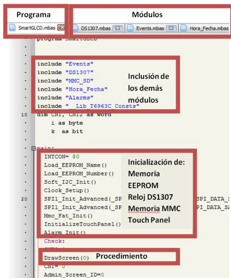
Figura 44. Estructura modular del programa del PIC18F8722.
