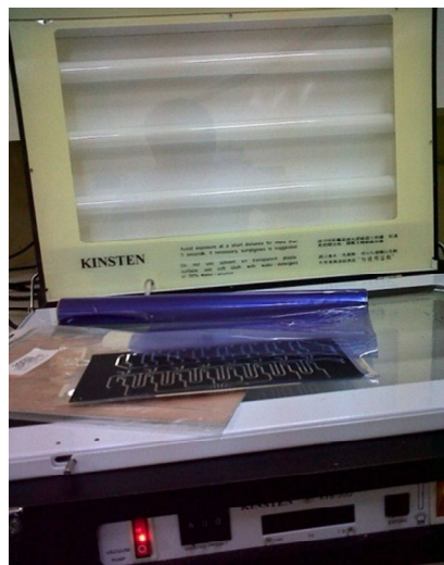
Figura 95. Tarjeta de cobre preparada para su exposición a los Rayos UV.
