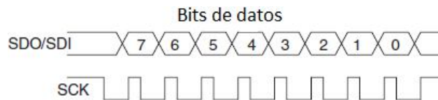
Figura 88. Lógica de transmisión de datos en un Bus SPI.
