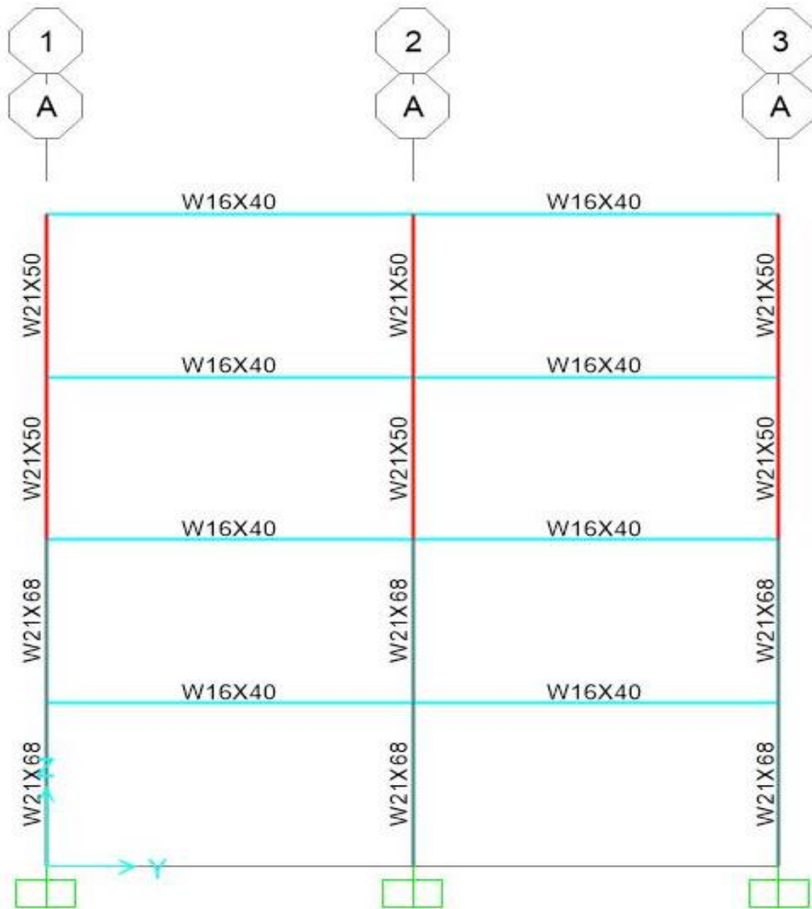
Ilustración AN-4. 7 Elevación estructural EJE-A (Fuente propia).
