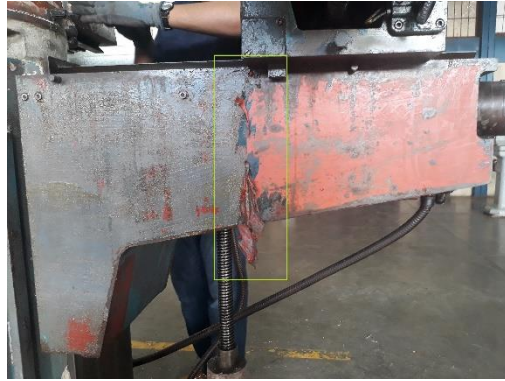
Figura 55: Remoción de la pintura.
