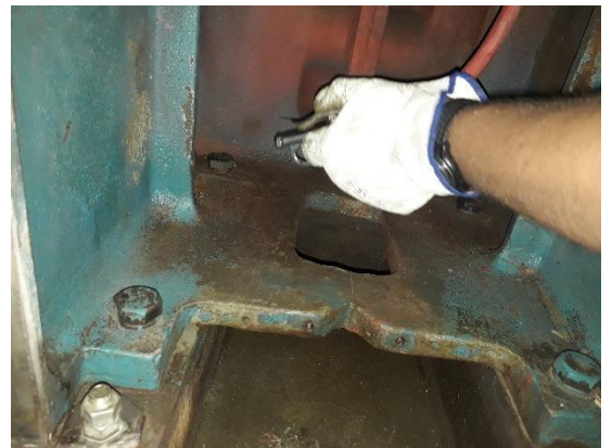
Figura 61: Deposito siendo sopleado para sacar pequeñas virutas del interior.
