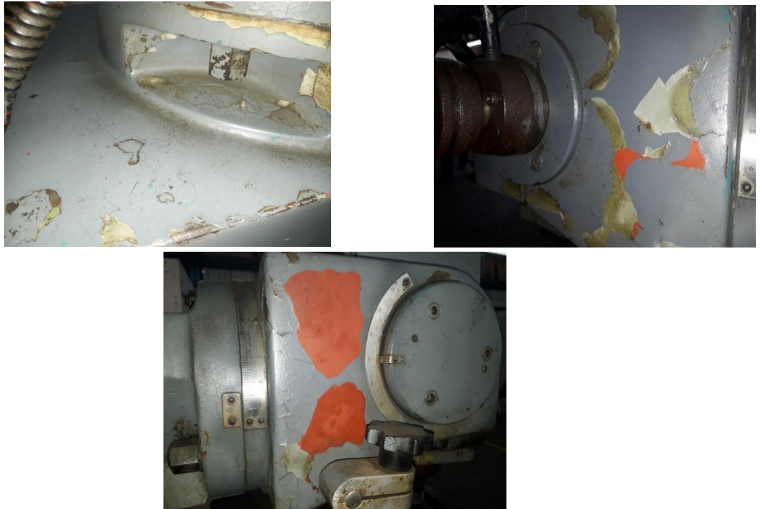
Figuras 45: Pintura de la superficie de la fresadora en mal estado.
