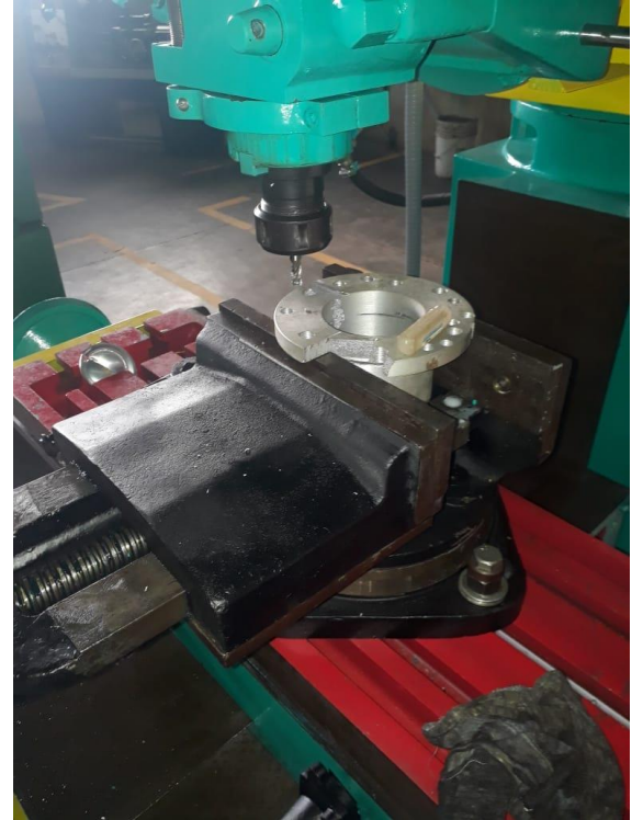
Figura 80: Prensa montada en la fresadora posterior al mantenimiento.
