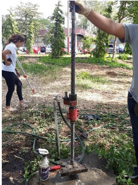
Figura 71: Limpieza del tornillo de desplazamiento de la mesa de trabajo.
