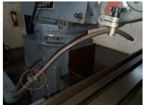
Figura 54: Ubicación de válvula de control de caudal.
