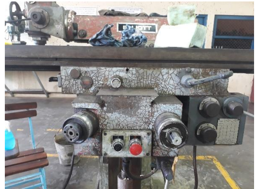
Figura 56: Fresadora con la pintura removida.
