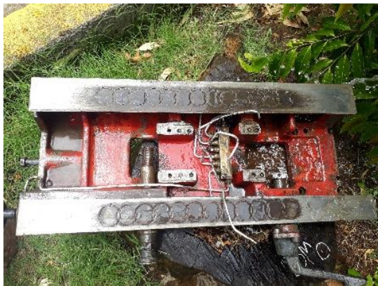
Figura 72: Limpieza de la silla y sistema de lubricación del tornillo de desplazamiento.
