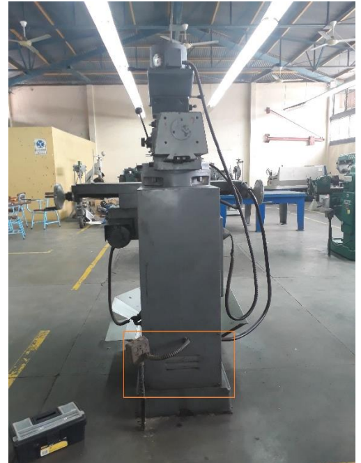
Figura 49: Ubicación de bomba en la fresadora.
