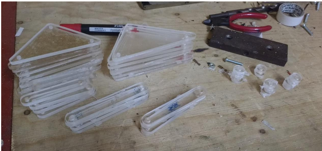
Imagen 209 Piezas mecanizadas en CNC
