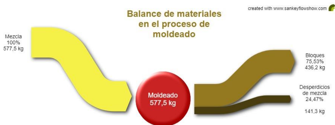
Ilustración 5: Diagrama Sankey del proceso de moldeado en la elaboración de bloques.
