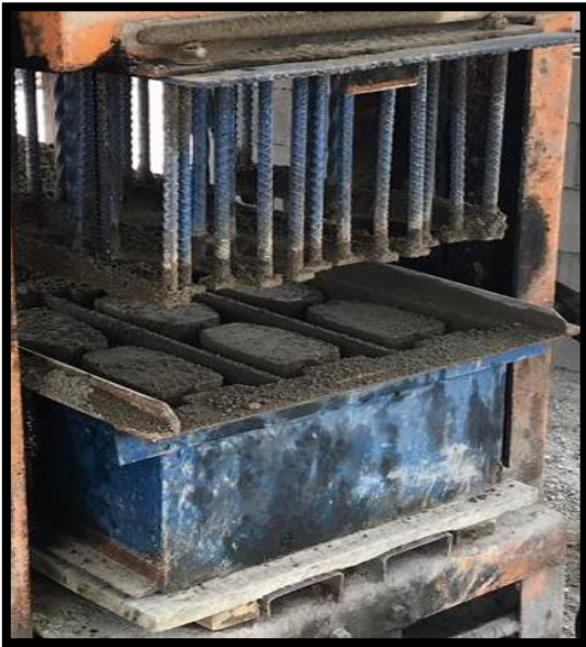
Fotografía 3: Molde Predeterminado para Bloques
