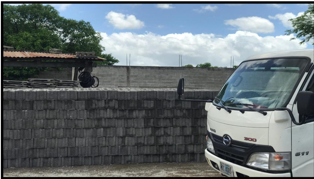
Fotografía 9: Secado y almacenado de bloques
