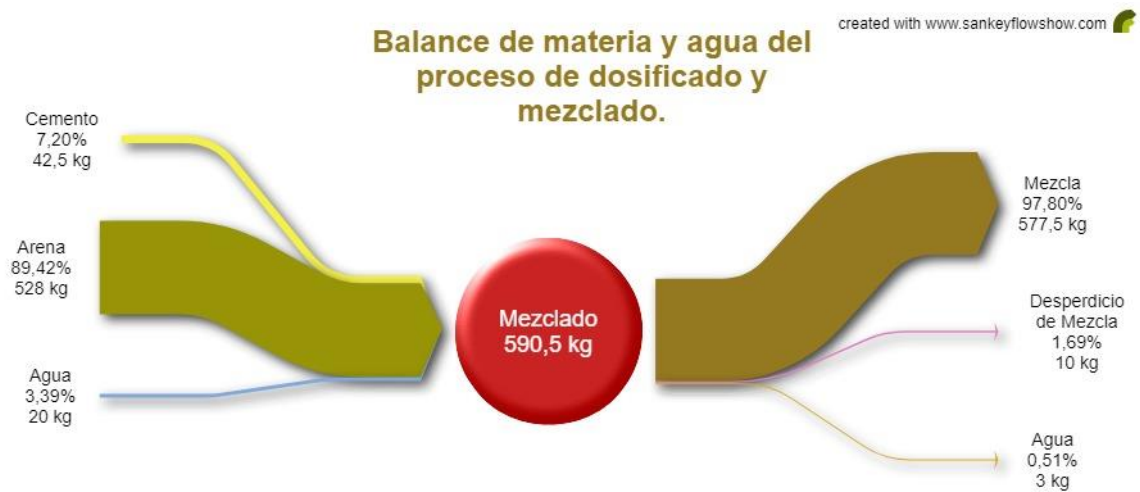
Ilustración 4 Diagrama Sankey del proceso de mezclado en la elaboración de bloques.
