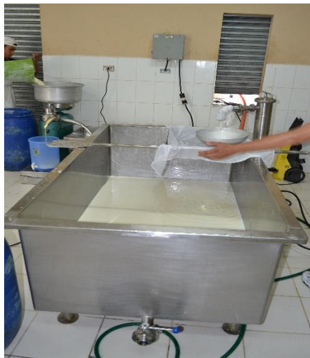
Figura 7. Etapa de filtración de la leche
