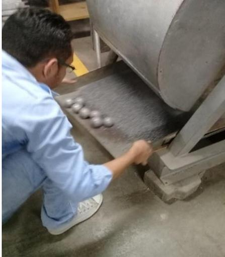
Ilustración 16 Material desgastado en La Máquina de Los Ángeles
