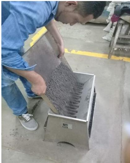
Ilustración 8 Proceso de muestreo para agregado fino
