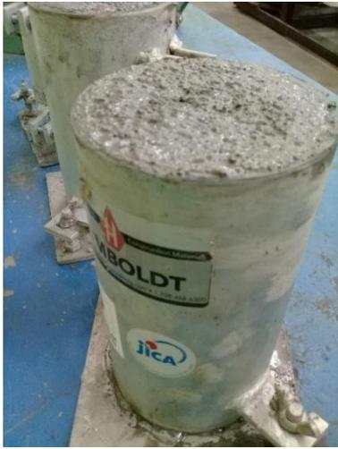
Ilustración 21 Desencofrado de cilindros de concreto
