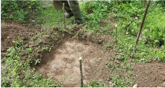
Ilustración 17: Nivelar el punto de altura que servirá como base para medir la infiltración de suelo
