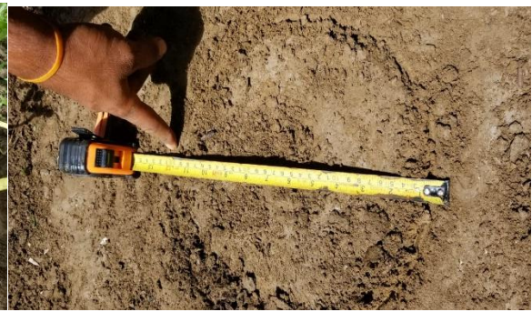
Ilustración 20: Medición de cuánta agua se infiltro en el lapso de tiempo estipulado para cada repetición
