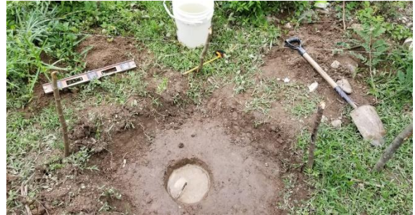
Ilustración 20: Medición de cuánta agua se infiltro en el lapso de tiempo estipulado para cada repetición
