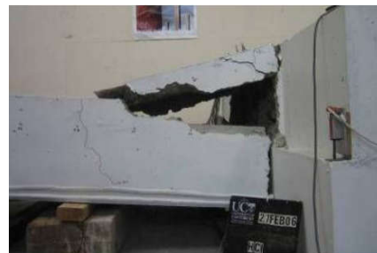
Figura 8.6. Falla de unidades de losa alveolar por momento positivo. Tomado de (Fenwick, Bul, & Debra, 2010)
