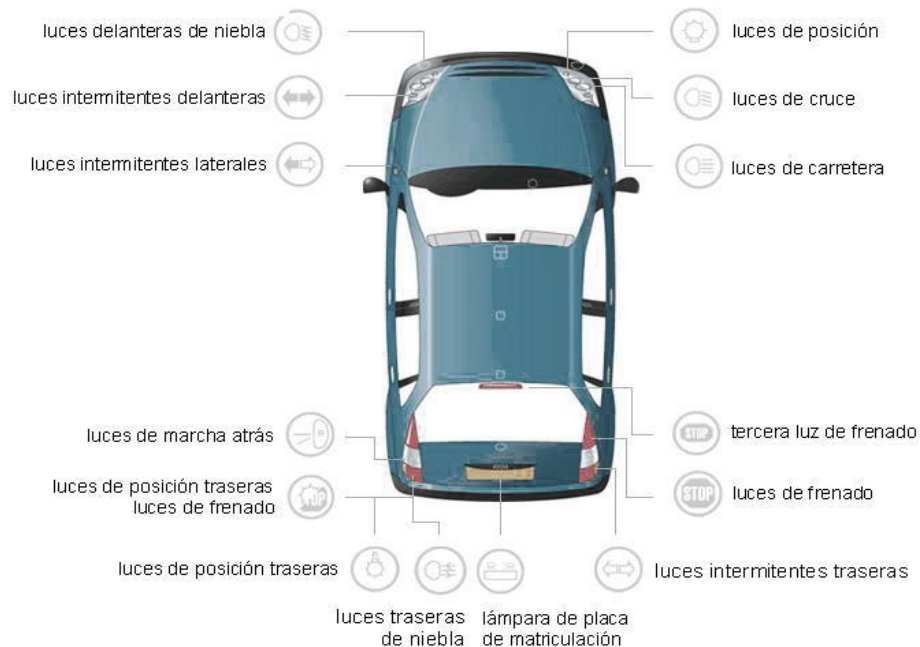
Foto 47: Sistema de iluminación.
