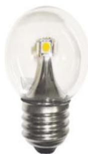
G45-LED/3W/30 Bombillo Led. Consumo de 3W. Equivalente a 25W Lumenes de 200 Luz Blanco Cálida. Base E27. Vida útil de 35000 Hras. Ancho 45mm, Alto: 79mm. Voltaje de 110V-127V.
