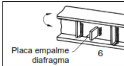
Figura 33: Ejemplo de soldadura de filete
