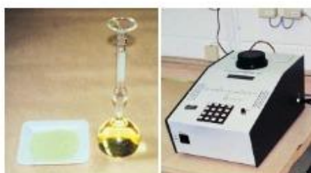
Fig. 2-47. La densidad del cemento (peso específico) se puede determinar por (izquierda) el uso del frasco volumétrico de Le Chatelier y queroseno (kerosene) o por (derecha) el uso de un picnómetro de helio. (68825, 68826)
