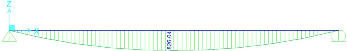
Figura No. 24 Análisis de momento máximo viga interior por sap2000
