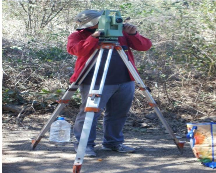
Foto 1: Estación total, utilizada para el levantamiento topográfico de la Comarca de Miramar.
