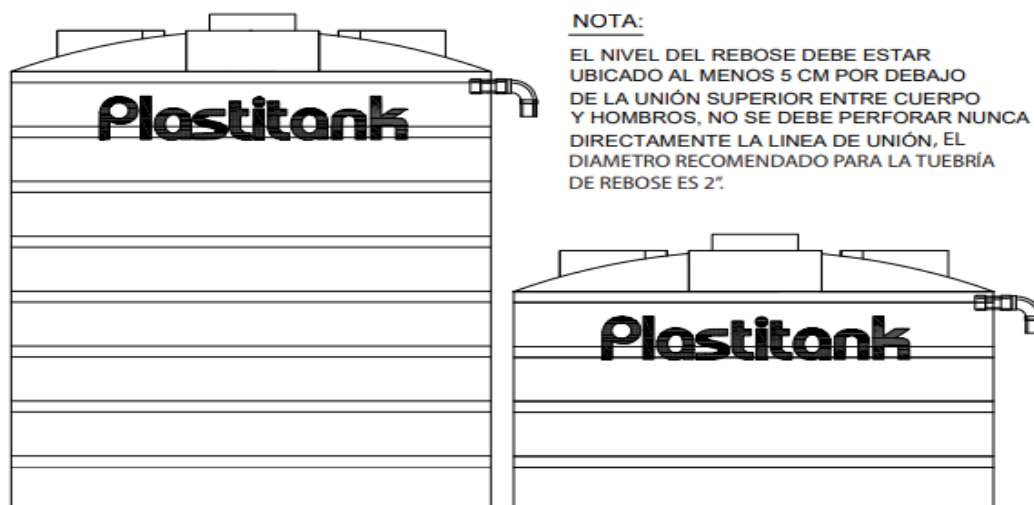
Ilustración 6: Nivel de rebose.
