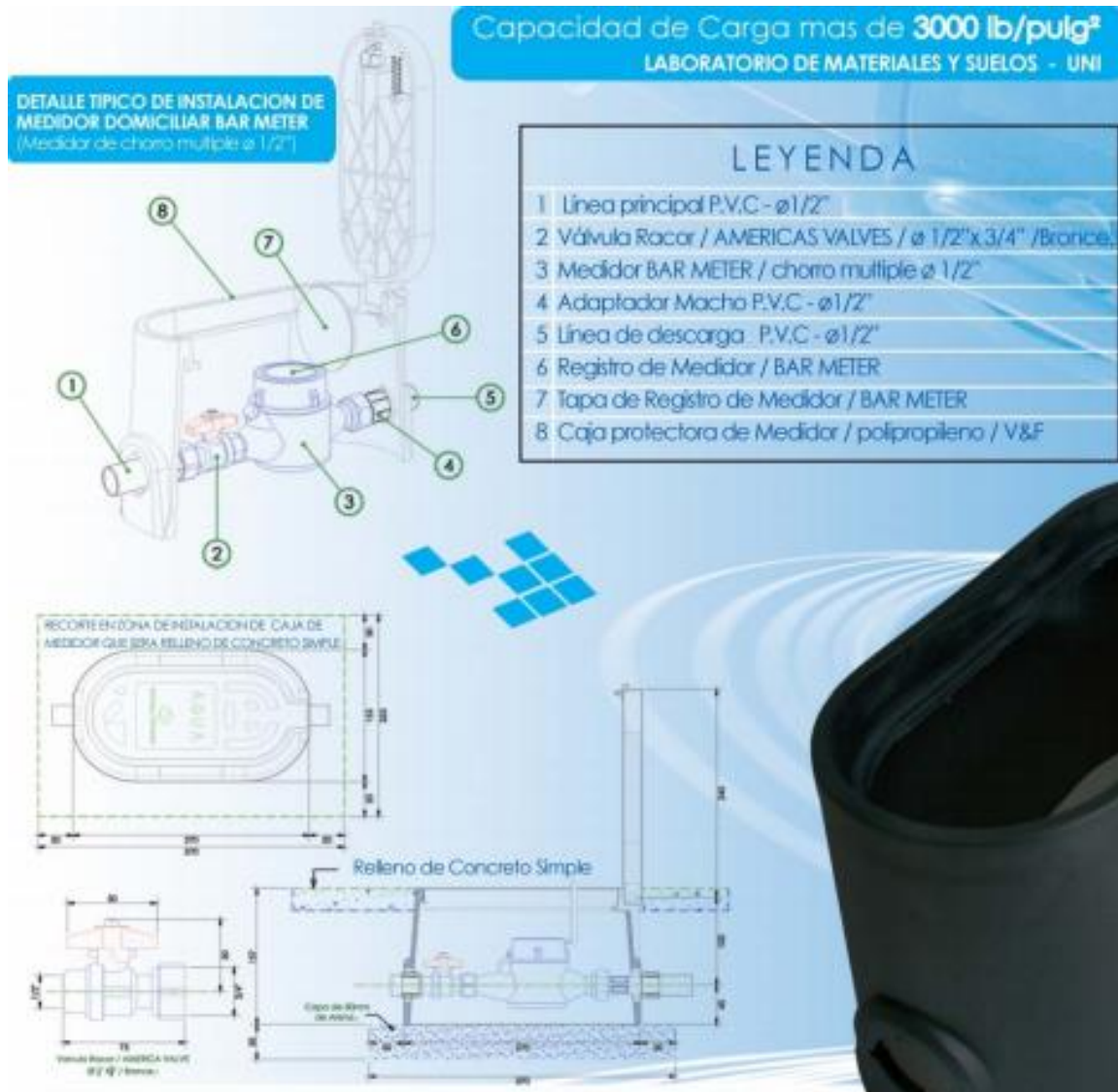
Ilustración 21: Detalle típico de instalación de medidor domiciliario.
