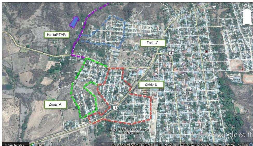
**Figura No. 8 Esquema del Trazado de La Red de Alcantarillado Sanitario<sup>7</sup>**
