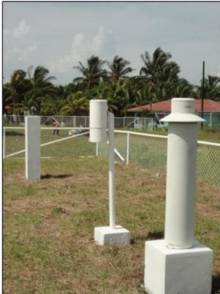
**Figura 16. Instrumentos recolectores de la precipitación**
