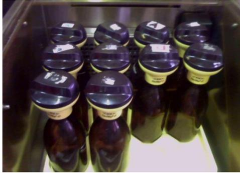
8. Para iniciar las cabezas, encienda el controlador del Oxitop presionando la tecla ON/OFF.
