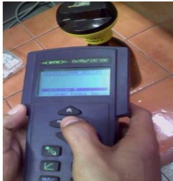
12. Seleccione el rango de medición y presione nuevamente RUN/ ENTER.
