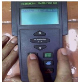
10. Coloque el controlador a una distancia máxima de 40 cm de cada cabeza.
