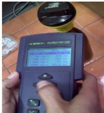
13. Con las flechas direccionales del controlador cambie el número de cabeza e inicie la activación presionando nuevamente RUN/ENTER.
