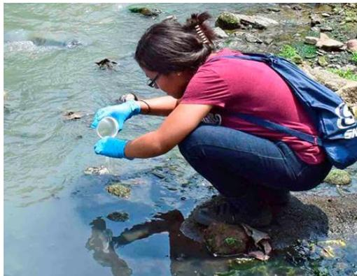
*Figura 10.* Sistema de muestreo aleatorio simple en una vertiente del Río Chiquito con agua contaminada con vísceras de animales, sangre, aguas de tenería y basura inorgánica. La muestra de agua se recolectó con un vaso de precipitado y luego se colocó en un tubo cónico de 50 mL estéril (Fuente: Propia).
