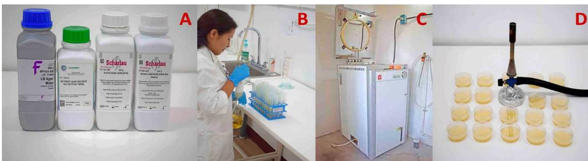
*Figura 11.* Preparación de medios de cultivos. A) Medios de cultivo utilizados; B) Dispensación de medios de cultivo C) Esterilización en Autoclave de los medios de cultivo por calor húmedo durante 15 minutos a 121°C y 100 Kpa; D) Medio de cultivo solidificado en placa Petri (Fuente: propia).
