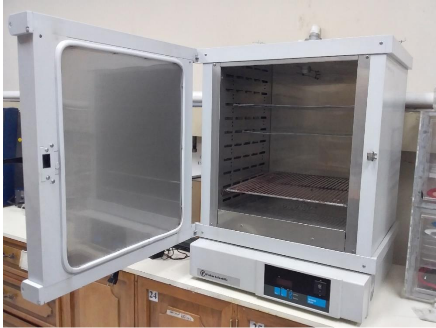
Figura 11.14 Horno convectivo utilizado en los procedimientos de secado
