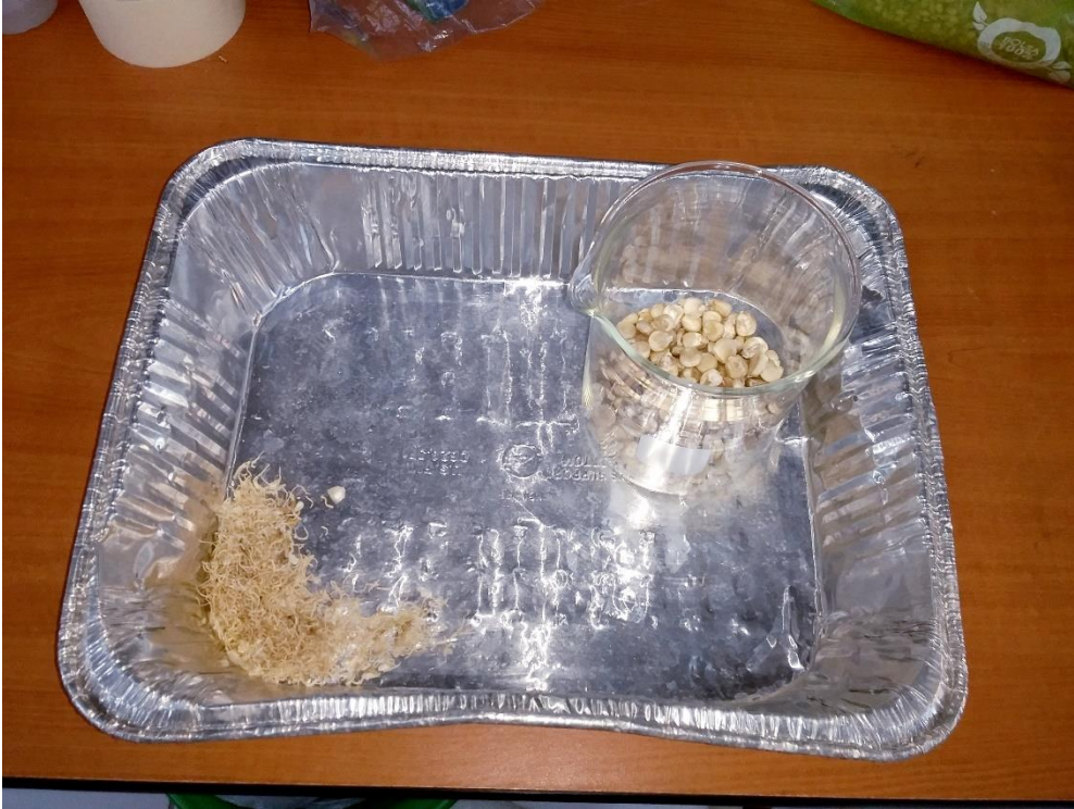
Figura 11.16 Muestra de malta verde de maiz antes de entrar al horno. Ensayo 5.1
