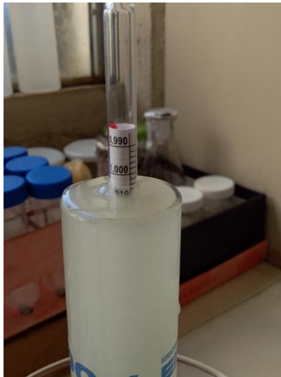
Figura 11.11 Medición de gravedad específica para Extracto de Agua Fría de ensayo 3.3
