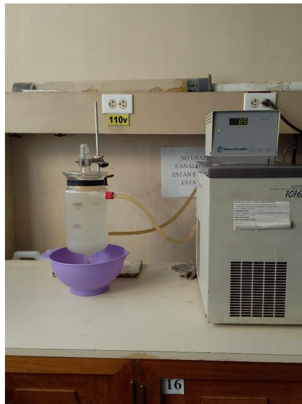
Figura 11.9 Sistema de enfriamiento para análisis de malta.
