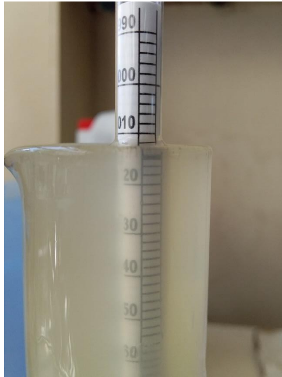
Figura 11.12 Medición de gravedad de Extracto de Agua Caliente de ensayo 3.1
