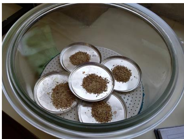
Figura 6.6 muestras de análisis de humedad a malta de maíz
