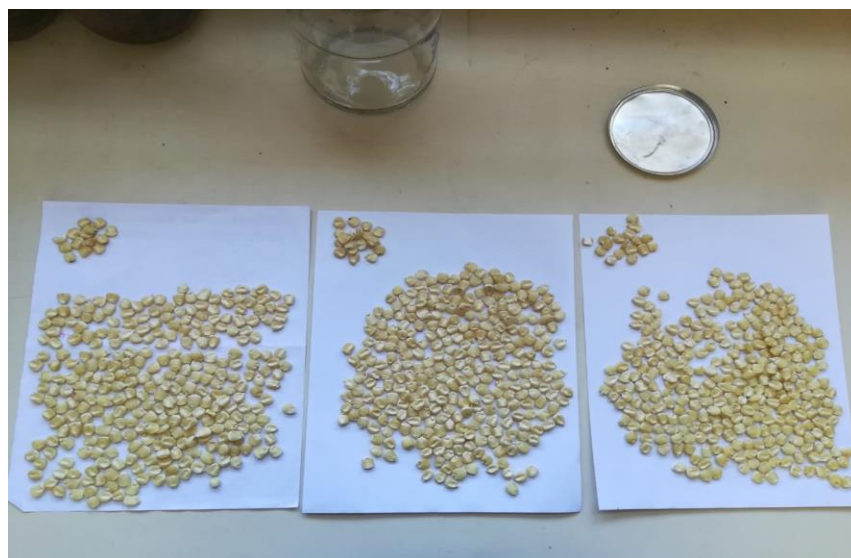
Figura 6.1. Revisión de muestras de maíz y contabilización de impurezas sobre una hoja de papel.
