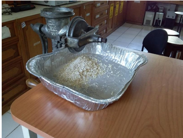
Figura 11.8 Molino manual utilizado para la molienda de malta.
