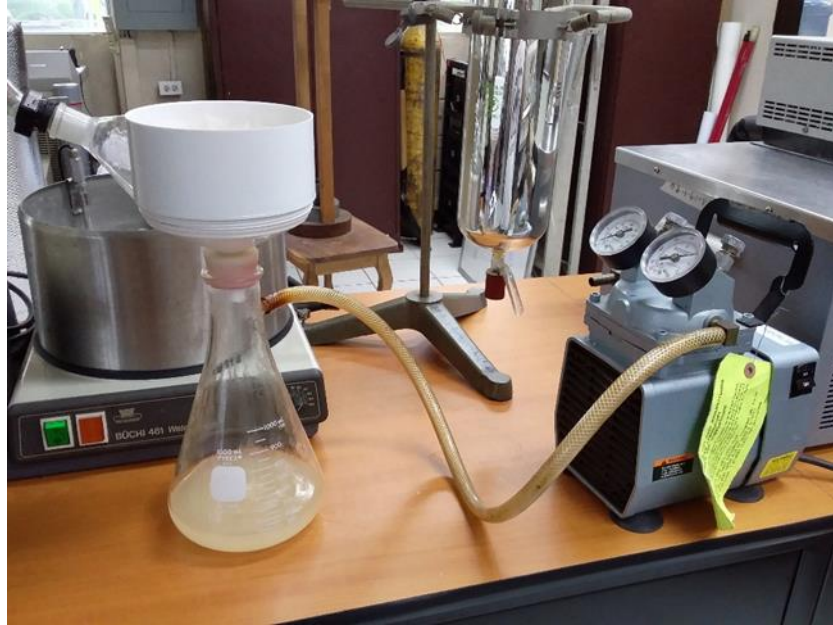
Figura 11.10 Sistema de filtrado de malta con bomba de vacío y erlenmeyer de kitasato
