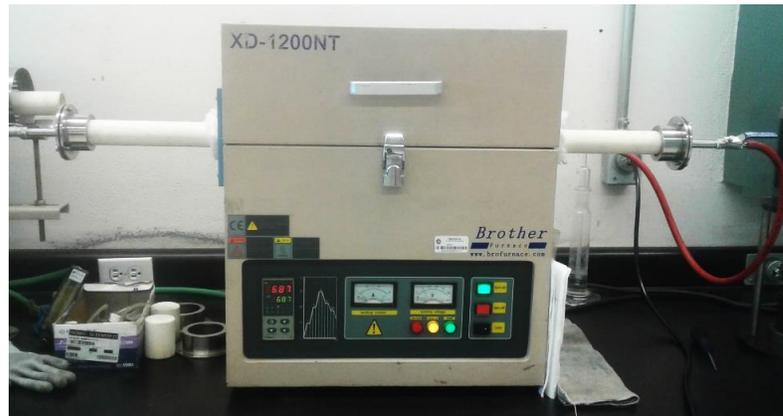
**Figura 19 Horno para la realización del tratamiento térmico.**
