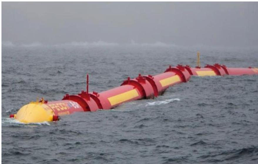
**Figura 7 Dispositivo Flotante para la conversión de Energía**
