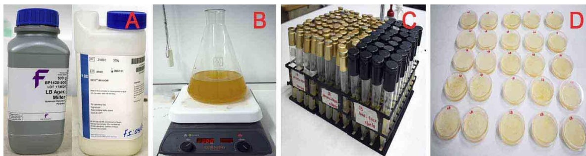
Figura 11. Preparación de medios de cultivo. A. Medios de cultivo LB y AM en sus envases, B. Calentamiento a 500°C y agitación a 31.42 rad/s del medio de cultivo en el Hot Plate, C. Dispensación del medio de cultivo en tubos de ensayo y D. Placa de Petri con el medio de cultivo solidificado (Fuente propia).
