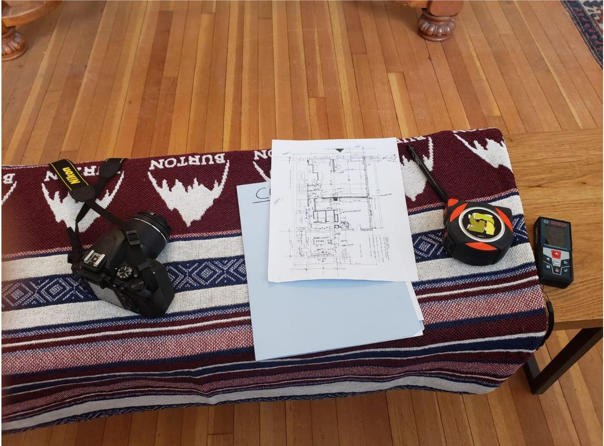
Ilustración 35: Herramientas utilizadas para el levantamiento y boceto a mano alzada.
