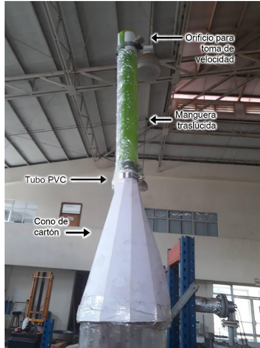
Figura 4.4 Cono invertido ubicado en la parte superior de la columna de fluidización.
