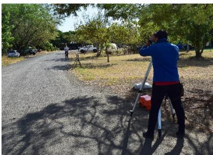
Fotografía 7: Levantamiento altiplanimétrico de calle que conduce de acceso Norte a estacionamientos.
