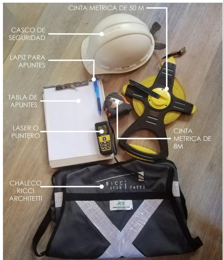
**Imagen 54** Instrumentos utilizados en Levantamientos Arquitectónicos
