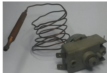
Fig.6 Contacto NC activado de forma térmica mediante una sonda de mercurio.
