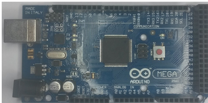
Fig.9 Placa de desarrollo Arduino Mega 2560, es basada en un microcontrolador ATmega2560.
