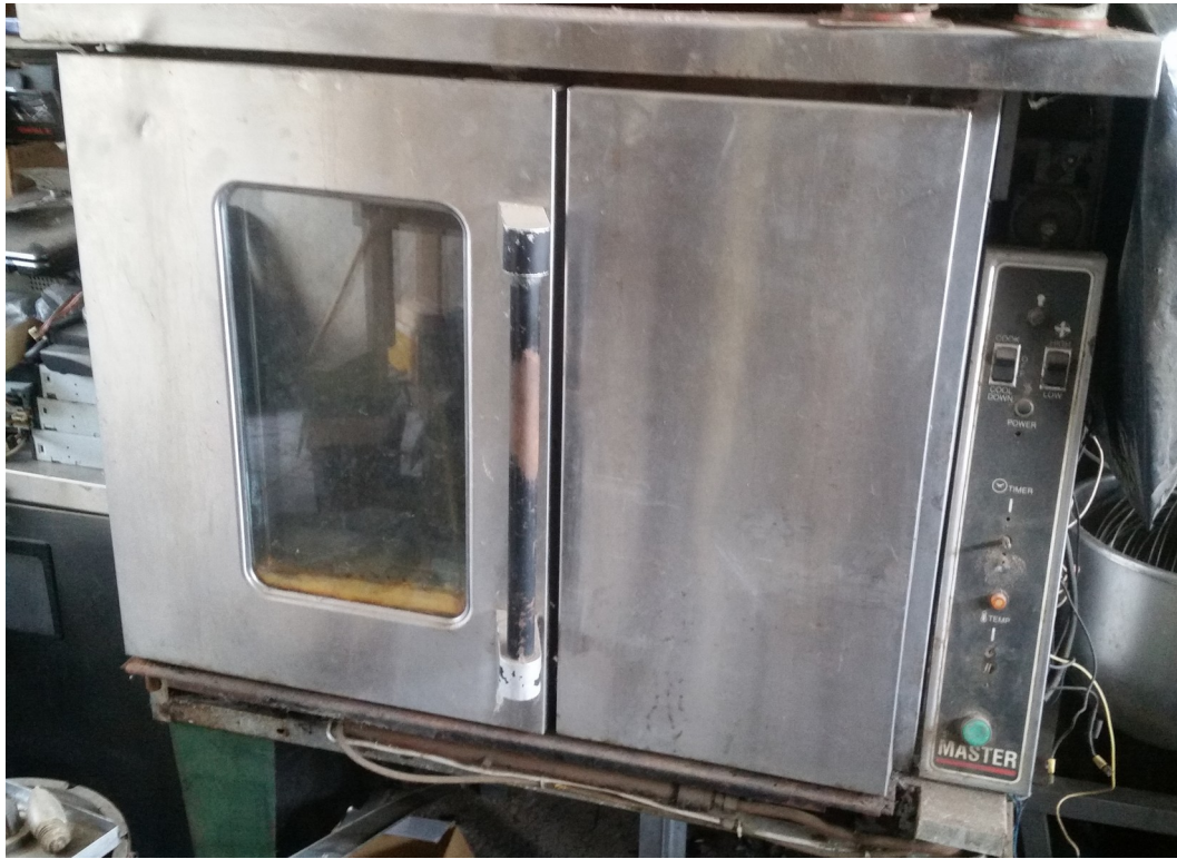
Fig.78 Horno a gas Garland The Master, fue despojado de su control original.
