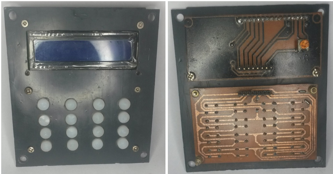
Fig.70 Cara frontal del prototipo, muestra como quedara asegurada la LCD y el teclado 4X4.
