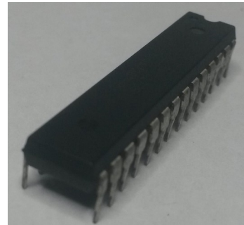
Fig.8 Microcontrolador Atmega8 de 28 pines.
