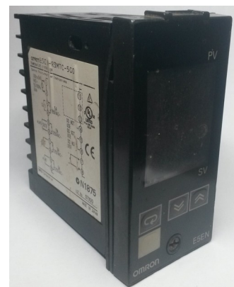
Fig.32 Controlador Omron E5EN con PID para hornos, no posee funciones de detector de llama.
