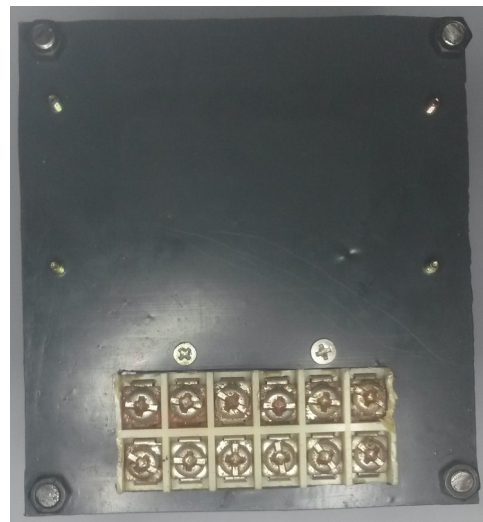
Fig.76 Parte trasera del prototipo con sus bornes de conexión.
