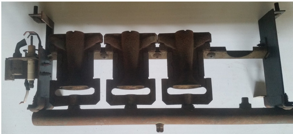
Fig.79 Soplete del horno a gas, a la izquierda se puede apreciar la ubicación del electrodo sensor y la salida del piloto.
