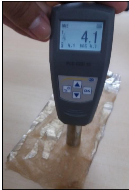
Figura 4.7 Uso del durómetro Shore D para medidas de dureza.
