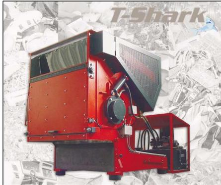
La T - Shark tiene como característica especial para los poderosos Molienda de plásticos, caucho, etc hasta 5 toneladas por Hora con la única WING - RAM. (De 8 mm. de tamaño de las partículas).
