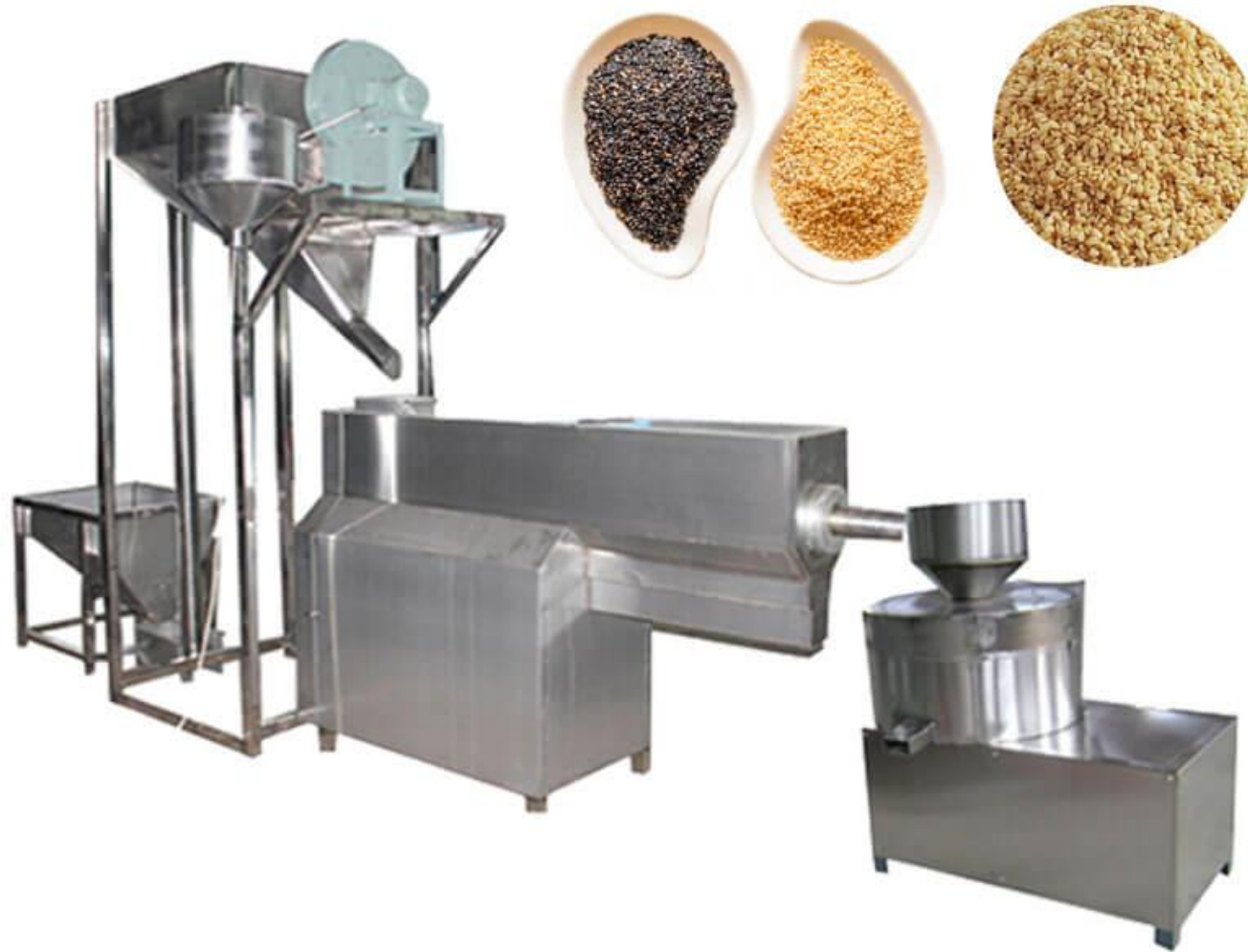
Figura 22. Línea del proceso productivo de ajonjolí natural
