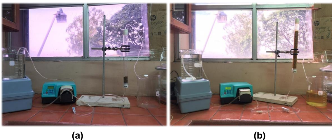
Figura 8. Equipo a utilizar para la realización de la columna empacada (a) sin encender bomba peristáltica y (b) después del tiempo transcurrido para la experimentación
