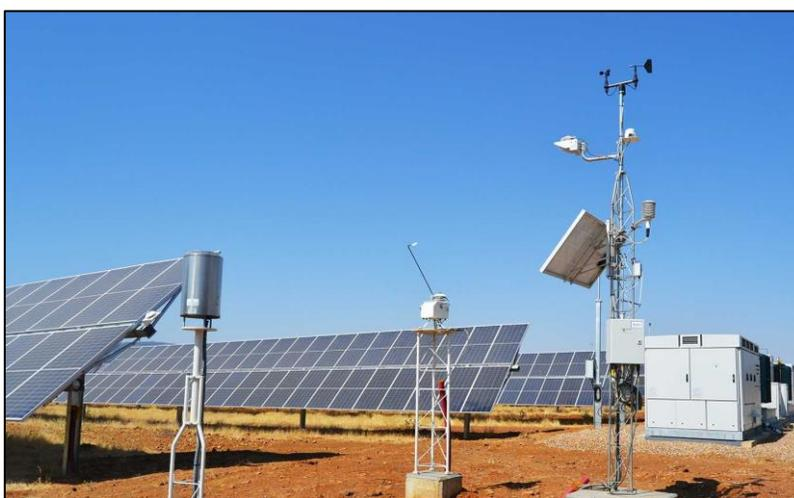
**Ilustración N°26.** Antena o Torre Climatológica
