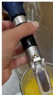
**Figura 8. Medición de °Brix.**
