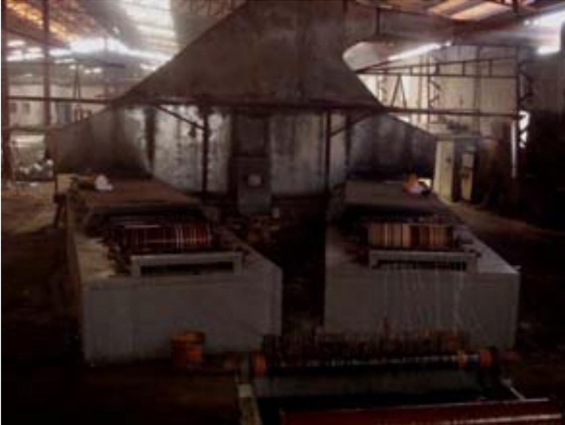
Luego el alambre pasa por las cámaras de secado y entra al horno de galvanizado, donde existe un crisol de zinc en las siguientes condiciones:
