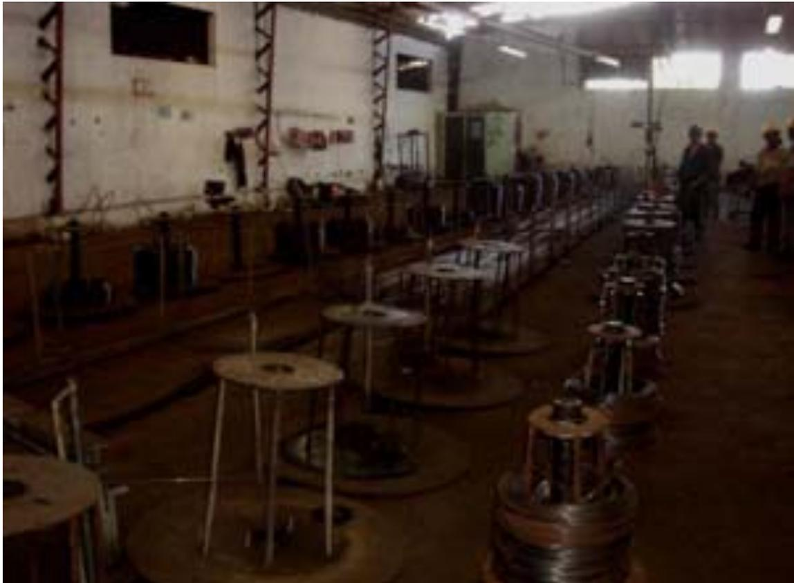
Luego que el alambre es alimentado en las bobinas como se muestra en la figura anterior, estos entran al horno de recocido continuo OFENBAU –FRITZ , de 18 m<sup>2</sup> a una temperatura de operación de 750 °C .
