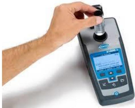
Figura 1\_10: turbidímetro portátil, tomado del sitio
