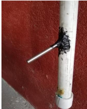
Figura 5\_13: sensor de temperatura incrustado en tubo que ingresa al contenedor
