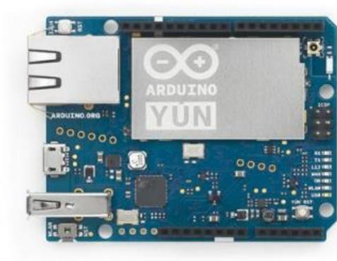
Figura 2\_1: Arduino Yun tomada de <https://www.arduino.cc>
