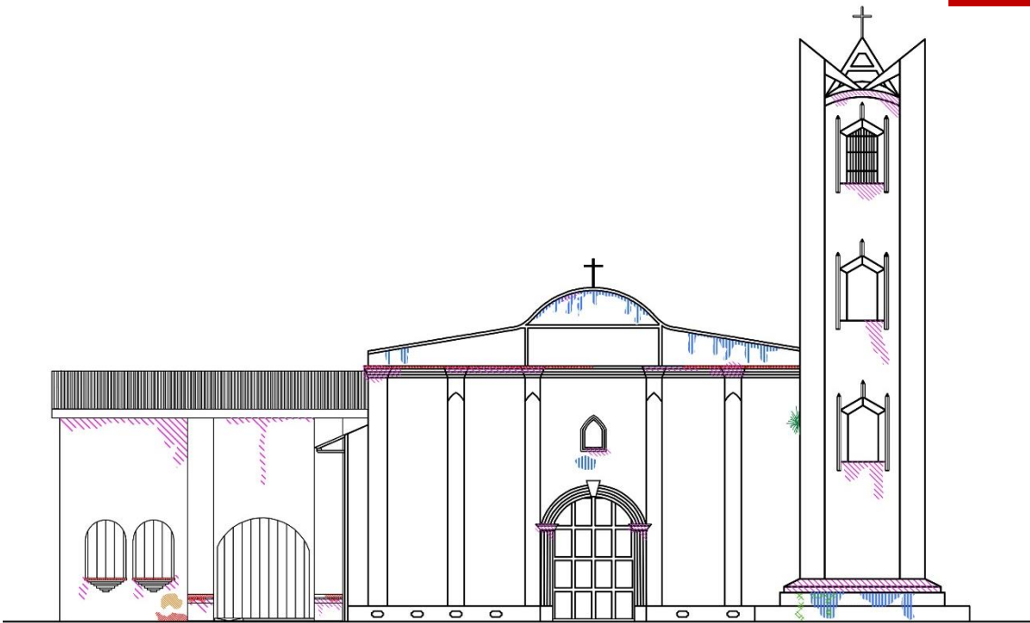
Ilustración 30. Ubicación de Patologías en elevación principal. Fuente: Autores Propuesta de Conservación y Plan de Gestión de la iglesia Santiago Apóstol de Telica, León, Nicaragua
