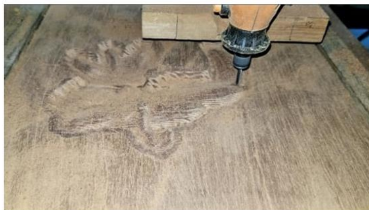
FIGURE 65 TALLADO EN LINUXCNC E IMPLEMENTACIÓN
