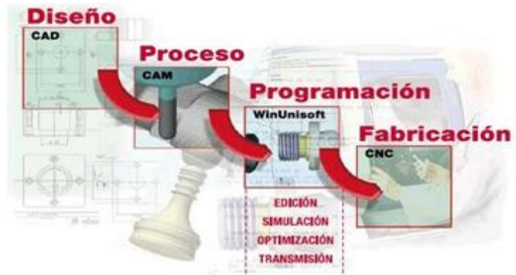
FIGURE 5 ETAPAS EN LA CREACIÓN DE UNA PIEZA CNC
