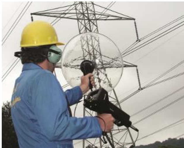
Figura. 9 Inspección de instalaciones eléctricas utilizando la técnica de ultrasonido Fuente extraída de: https://www.uesystems.com/
