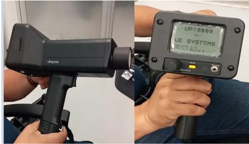
Figura. 27 Equipo Ultra probé 10000., Ultrasonido Propagado en el Aire Fuente extraída de: https://www.uesystems.com/
