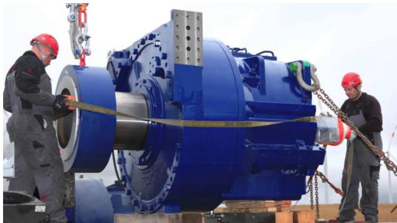
Figura. 17 Caja Multiplicadora del Aerogenerador Fuente extraída de: https://www.uesystems.com/
