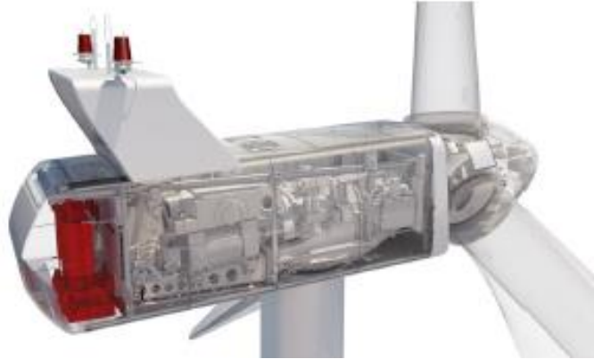
Figura. 19 Ubicación del transformador en la turbina del Aerogenerador Fuente extraída de: https://www.uesystems.com/
