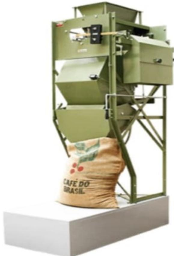
*Ilustración 5 Ensacadora automática*
