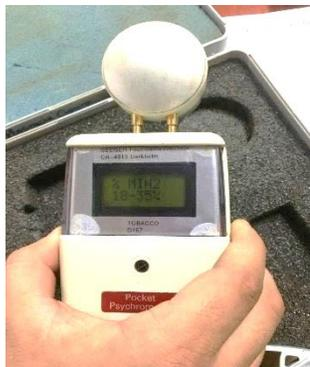
*Ilustración 8. Valoración del grado de humedad. MS-320 Ketech Industry*
