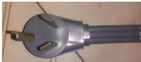
Ilustración N°8: Cable de corriente trifásico 220v.
