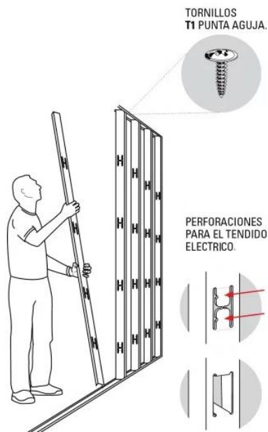
Ilustración N°21: fijación de parantes intermedios.
