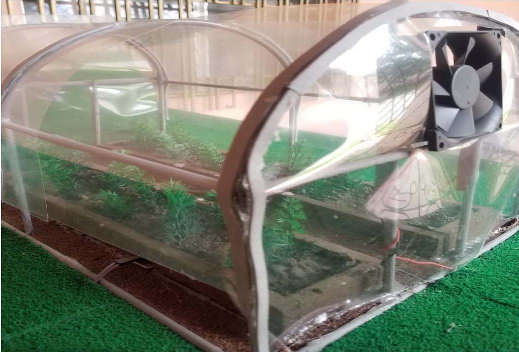
**Ilustración 57:** Prototipo a escala del sistema de riego y fertilización mediante sensores de humedad #5 **Fuente:** Elaboración propia.
