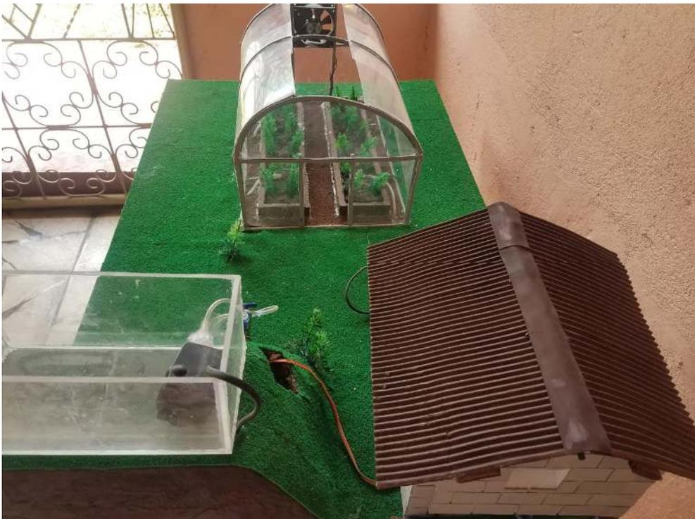
**Ilustración 56:** Prototipo a escala del sistema de riego y fertilización mediante sensores de humedad #4 **Fuente:** Elaboración propia.
