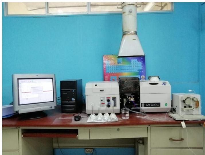
**Figura A.1** Equipo de Absorción Atómica con llama.
