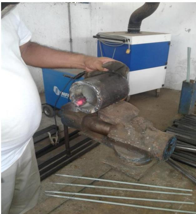
Corte y relleno con soldadura **6011** en revestimiento externo de cilindro de acero **SAE 1020** de sistema de agua, cabezal principal entrada al conducto de agua a sarta de perforación y asentamiento de bolineras de **diámetro interior 2"**
