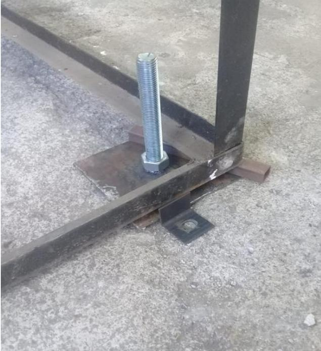
Sistema de nivelación de perforadora rotativa, conformado por placa de acero **SAE 1020** con barra de hilo sinfin de 1 pulgada de diámetro con tuerca de diámetro interior de 1 pulgada. Soldada con electrodo **6011**.
