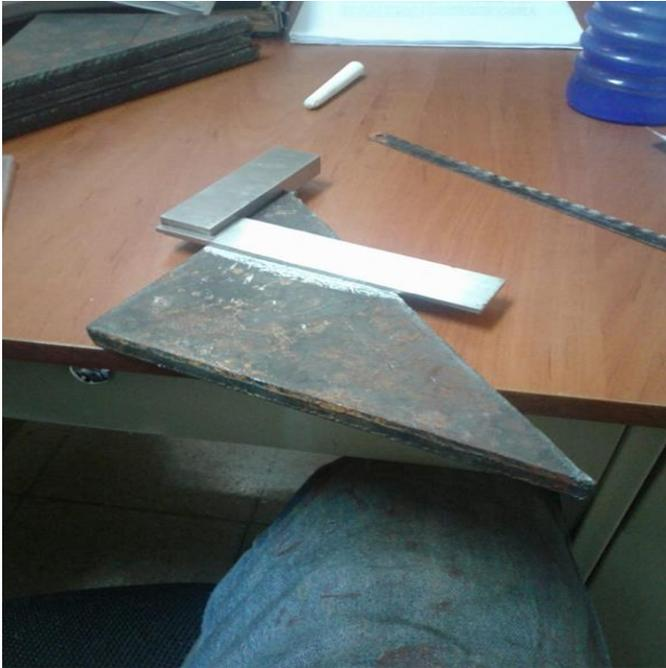
Acero **SAE 1020** ocupado para los órganos de corte de la broca con cuatro veletas unidas con hilo de soldadura **E-6011** con ángulo de penetración de **45°**.
