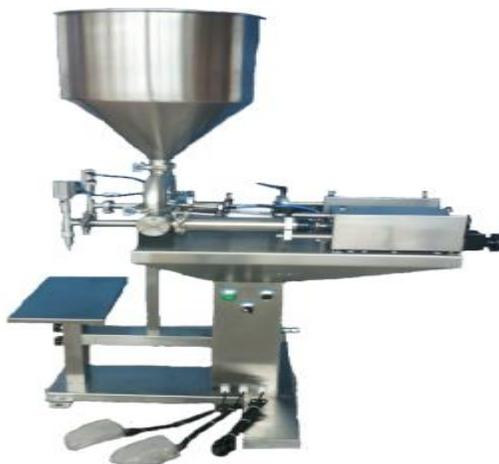
**Figura 3.34** Llenadora semiautomática del fabricante "Tecnipac"
