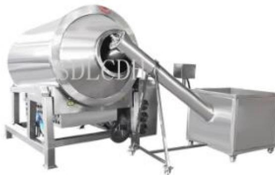
**Figura 3.20** Tostadora de cacao de la empresa "Shandong Longchang Duohui Machinery Technology Co., Ltd".
