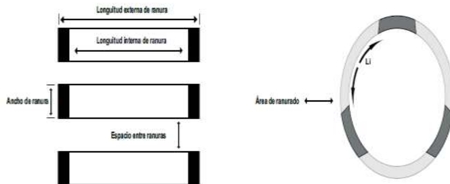
Imagen # 22: Forma de rejilla para tuberías de PVC
