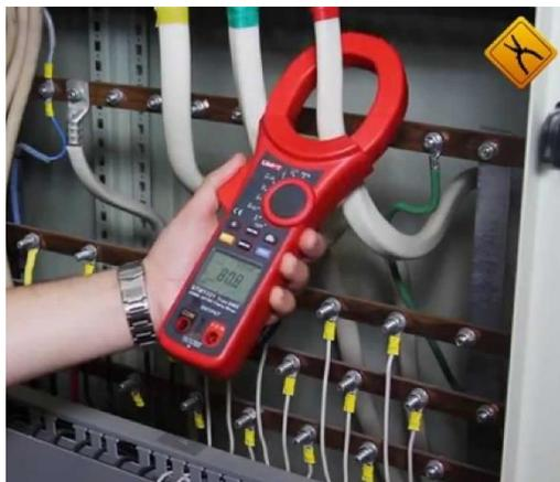
Fig. 38. Medición para parámetros eléctricos.
