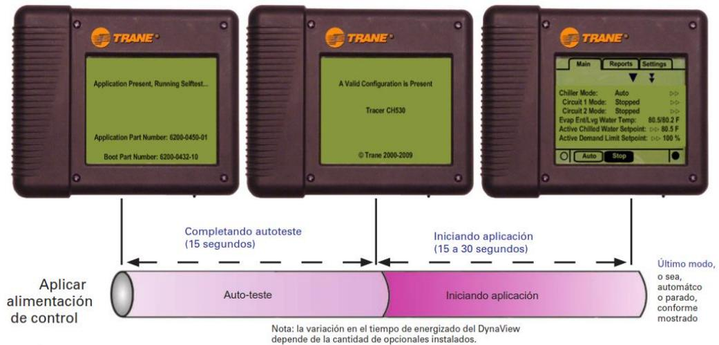
Fig. 14. Control energizante de un sistema Chiller.
