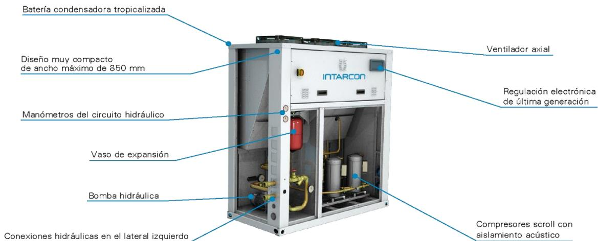
*Fig. 4. Componentes principales de un chiller.*
