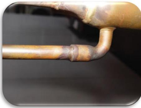
Fig. 28. Ensanchado de tubería.
