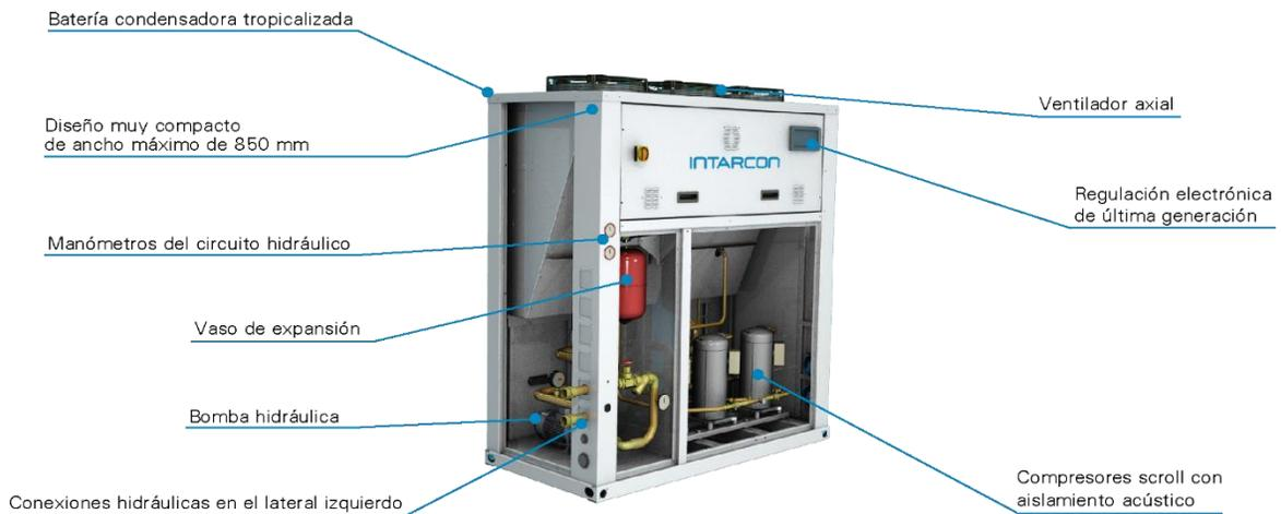
Fig. 4. Componentes principales de un chiller.
