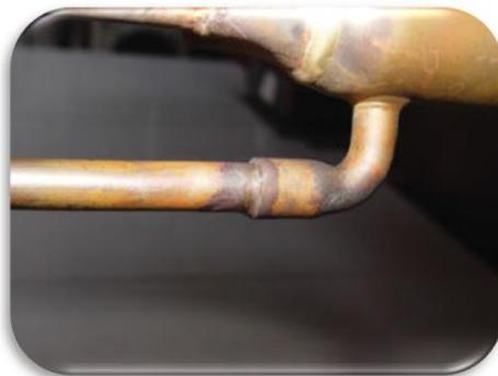
*Fig. 28. Ensancho de tubería.*
