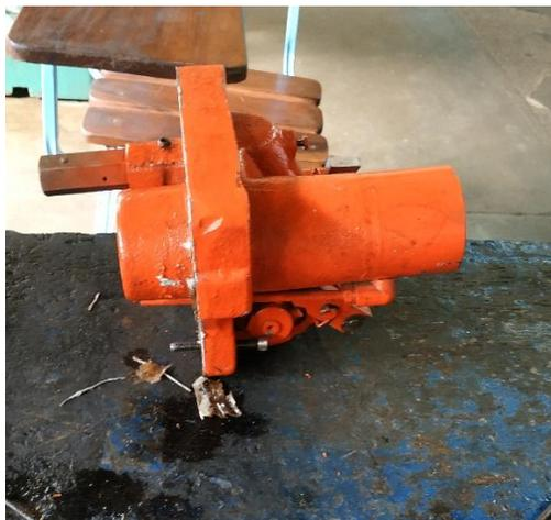
Fig. 14 Bomba hidráulica en proceso de reparación y montada en máquina.
