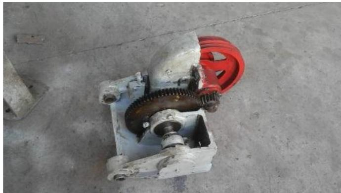
Fig.13 Sistema de transmisión de movimiento del brazo de corte.
