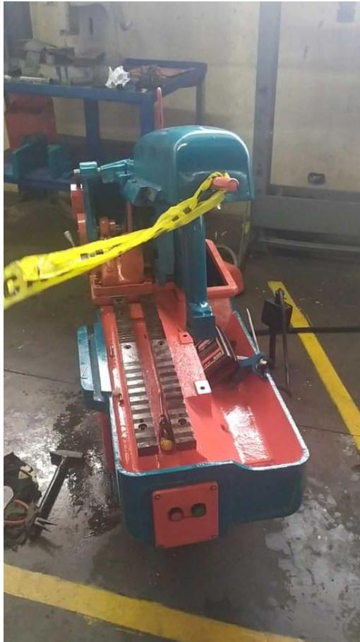
Fig.18 Prueba de funcionamiento del sistema hidráulico de la máquina, sistema de retención y ascenso automático del brazo de corte.
