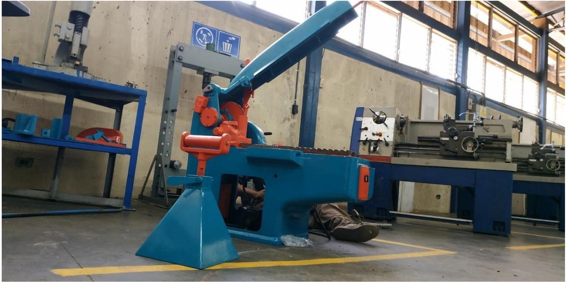
Fig. 16 Prueba de movimiento en brazo elevador y funcionamiento correcto del arrancador.
