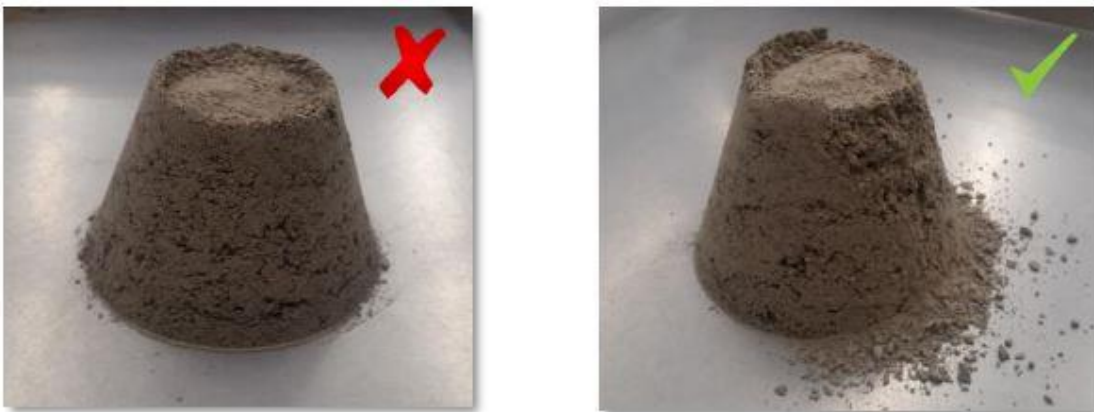
Imagen 23. Muestra saturada y muestra saturada superficialmente seca
