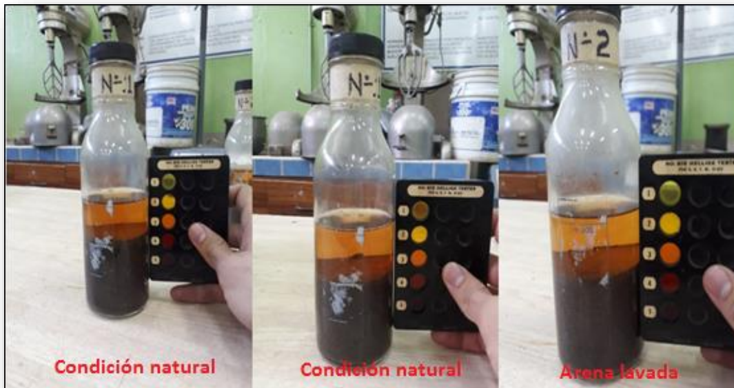
Imagen 27. Comparación entre la solución con arena y la placa orgánica de colores Gardner – Banco San Caralampio
