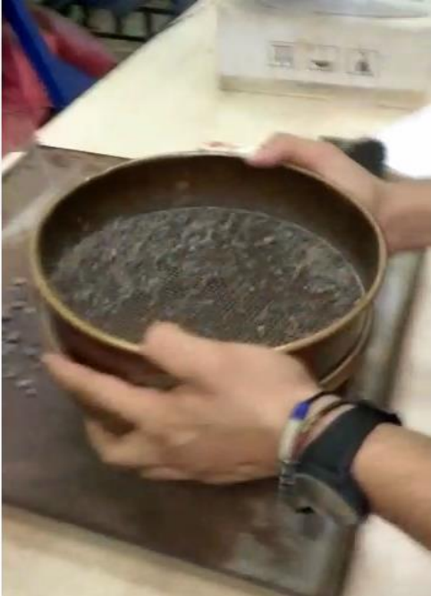
Fotografía A8(e). Ensayo de granulometría
