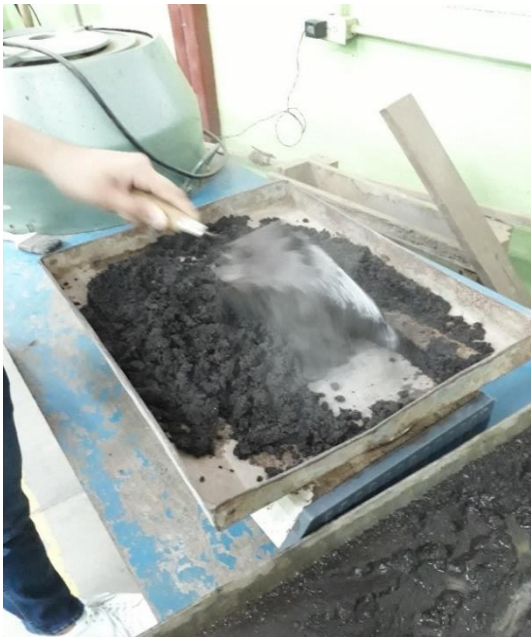
Fotografía A8(c). Ensayo de gravedad específica y porcentaje de absorción
