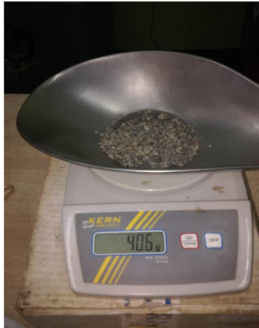
Fotografía A8(f). Ensayo de granulometría
