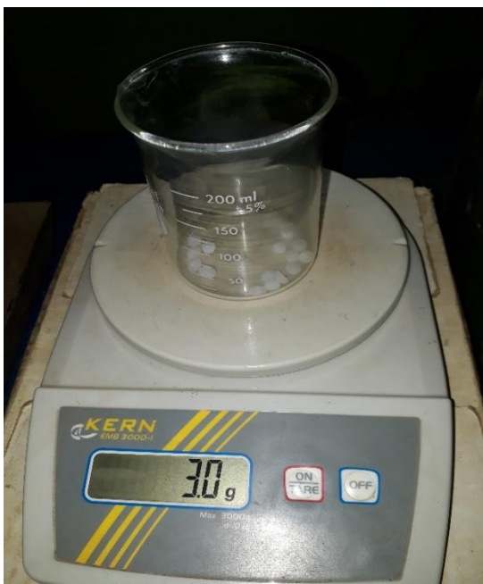
Fotografía A8(g). Ensayo de impurezas orgánicas
