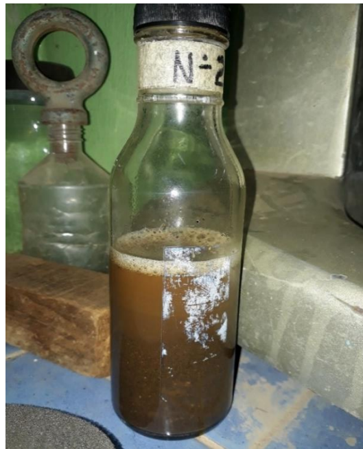
Fotografía A8(h). Ensayo de impurezas orgánicas
