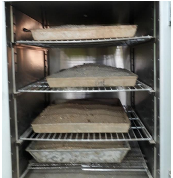
Fotografía A8(b). Ensayo de contenido de humedad.
