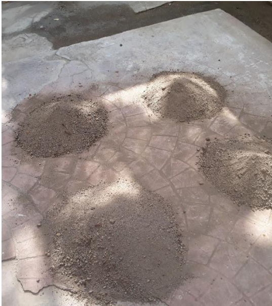
Fotografía A8(a). Ensayo de reducción de muestras
