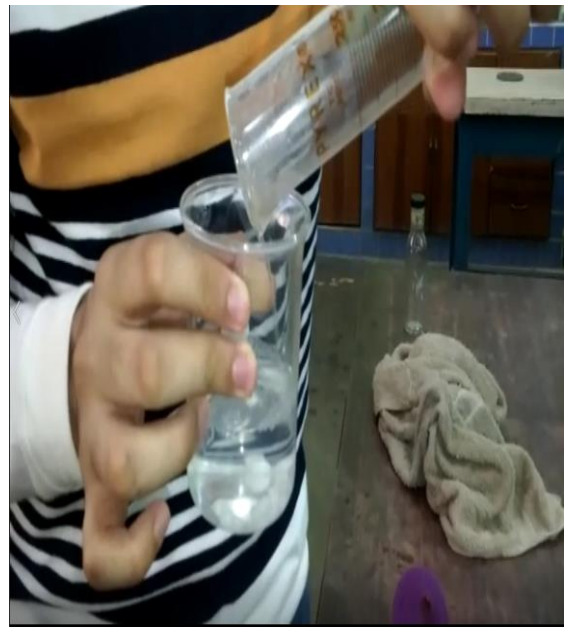
Fotografía A8(d). Ensayo de impurezas orgánicas
